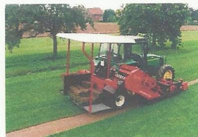
Leichte und zeitsparende Anbringung binnen weniger Minuten (Abb. Turf Tick getrennt). Der Turf Tick wird an den Traktor mit einer Halterung angehängt, die speziell entworfen wurde, um an spezielle Traktorenmodelle zu passen. Der Rahmen bleibt am Traktor, wenn der Turf Tick getrennt wird.
